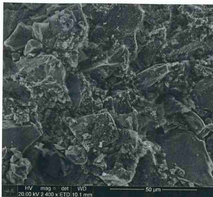
Figura 9. Imagem obtida pelo MEV de uma pelota de composição 92% minério de ferro e 8% de aglomerante, após aquecimento à 900°C por 50 minutos sem redutor no cadinho. Aumento de 2400 vezes.
